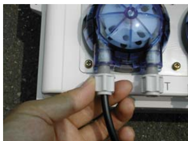
①吸込側および吐出側のポリウレタンチューブをはずす
