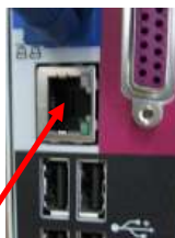
パソコンの LAN ケーブル接続部
