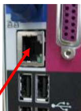
パソコンの LAN ケーブル接続部
